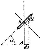
rührungspunkt der Rolle auf der Fläche sich nur in der Richtung der Stange verschieben lässt, und dass die Richtung der Rollenebene gleichzeitig beliebig verändert werden kann. Verschiebt man nun die Stange AR parallel zu sich selbst, so dass A die zu AR senkrechte Bahn  $ds$  beschreibt, so rollt die Rolle in der Richtung ihrer Ebene. Dabei verschiebt sich der Punkt R auf
